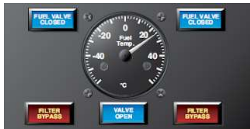
Slika 10: Indikator temperature goriva. [1]
