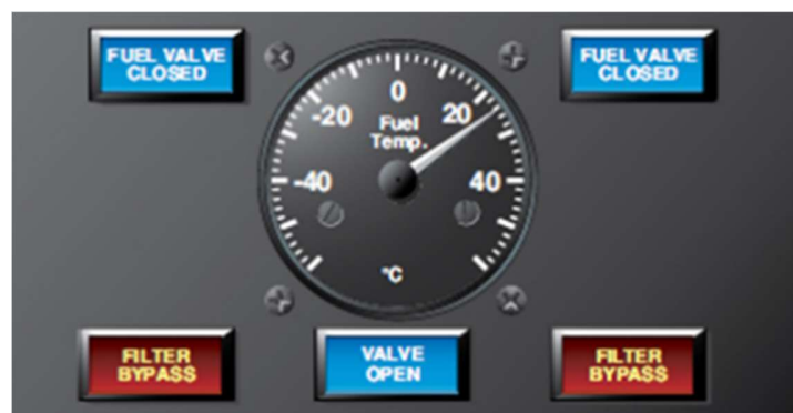
Slika 5: Indikator temperature goriva. [1]
