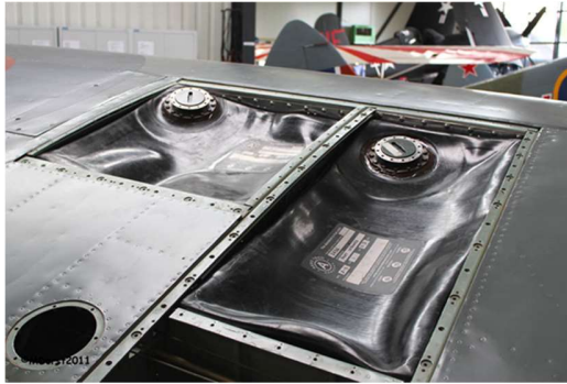
Slika 3: Prikaz pomičnog spremnika. [2]
