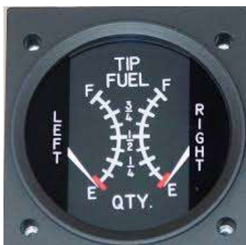
Slika 8: Indikator mase goriva. [1]
