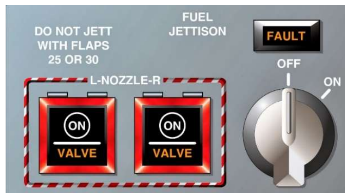
Slika 6: Prikaz instrumenta za izbacivanje goriva. [1]
