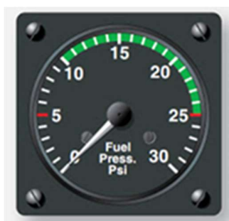
Slika 11: Indikator tlaka goriva. [1]
