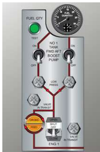
Slika 12: Indikator promijene ventila spremnika goriva. [1]
