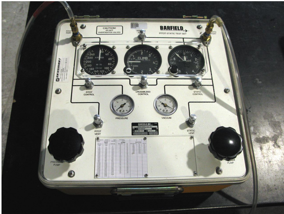
Slika 7. Ispitni uređaj „Barfield“, model 1811GA
