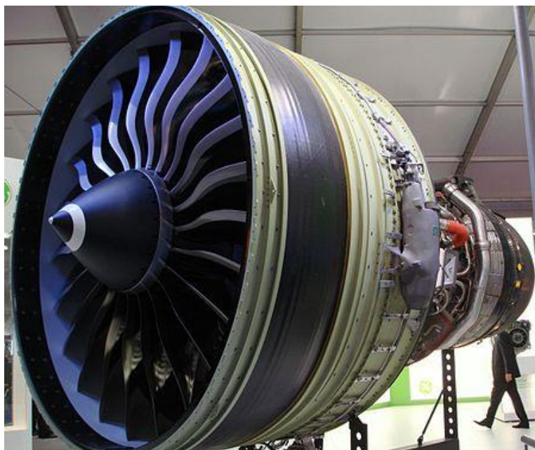
Slika 14. GE90 mlazni motor [42]
