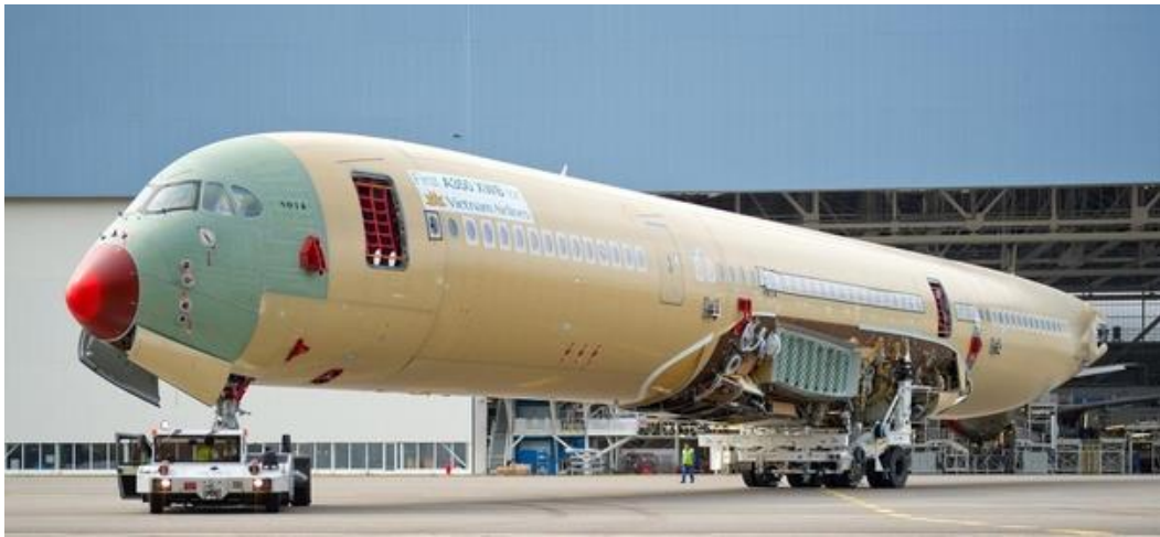
Slika 19. Kokpit od aluminija kod modela A350 [51]
