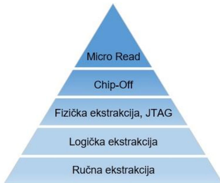
Slika 3. Piramidalna struktura klasifikacije metoda ekstrakcije podataka Izvor: [37]
