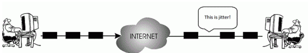
Slika 10. Prikaz jittera prilikom transmisije, [18]
