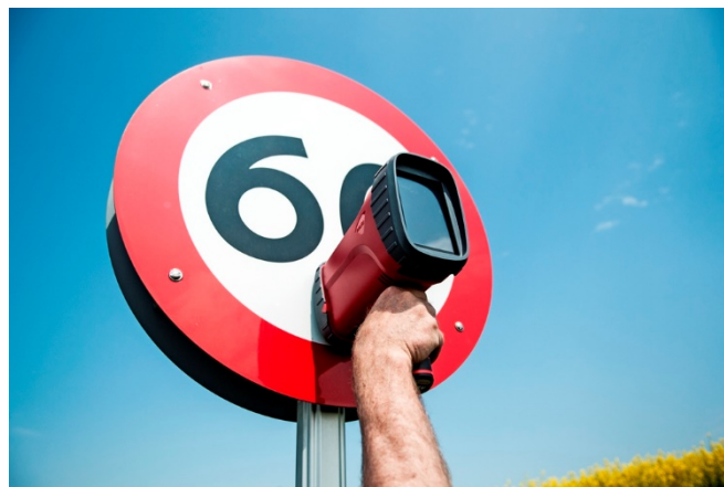
Slika 12. Ispitivanje retrorefleksije prometnih znakova
