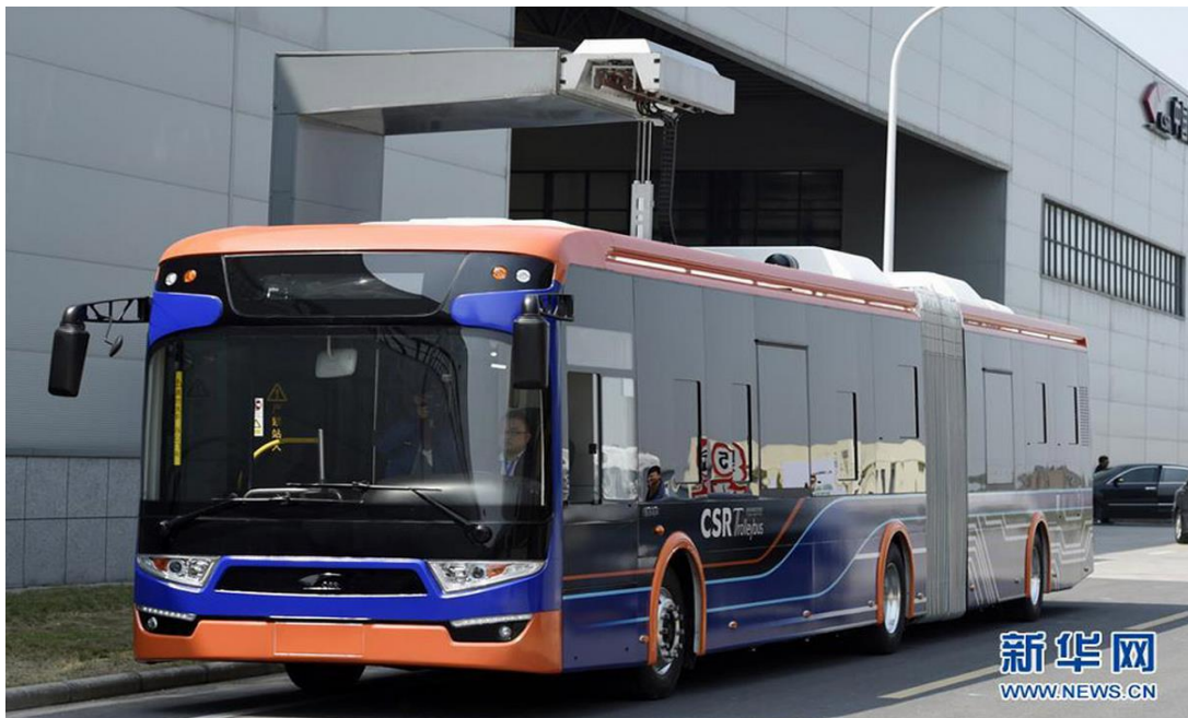
Slika 14. Punjenje superkondenzatora električnog autobusa
