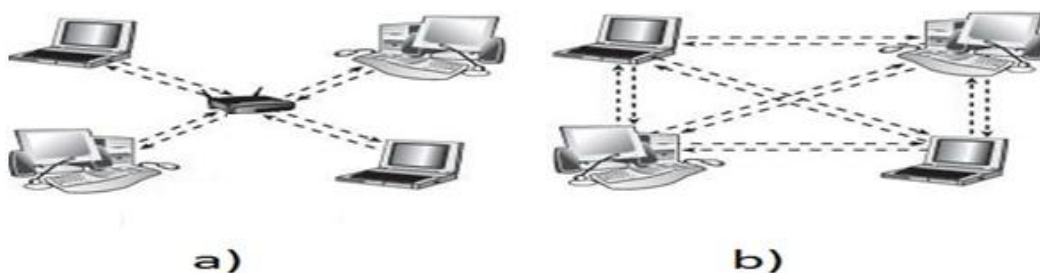
Slika 2. Kategorije WLAN-ova: a) Infrastrukturni WLAN i b) neovisni WLAN
