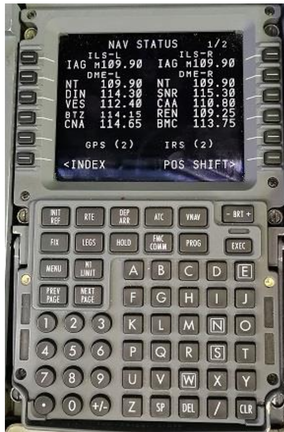
Slika 21. Prikaz radio-navigacijskih sredstava
