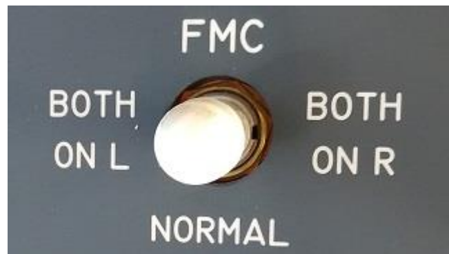
Slika 20. FMC Source Selector
