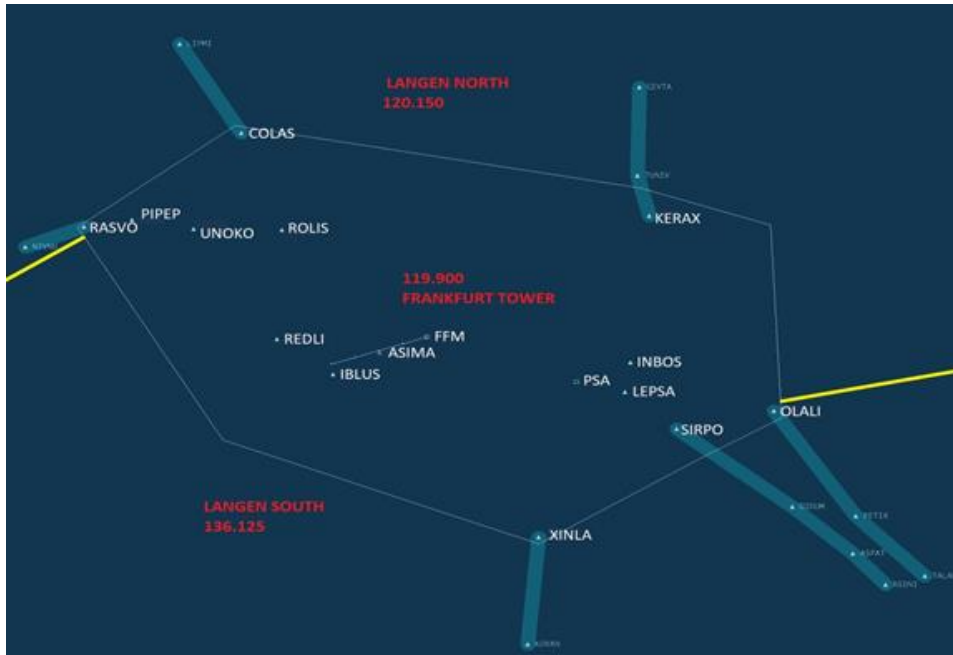
Slika 1: Radarski prikaz zračnog prostora na BEST-u
