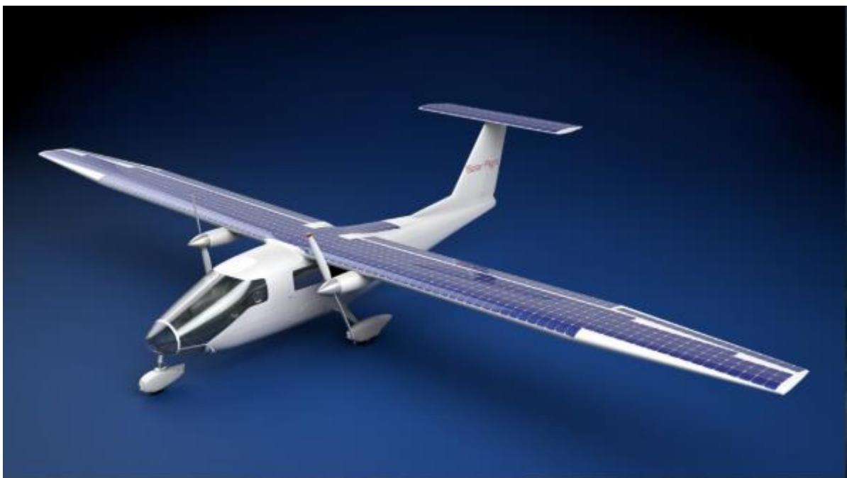
Slika 7. Prikaz solarno-električnog šes zrakoplova sa šest sjedala
