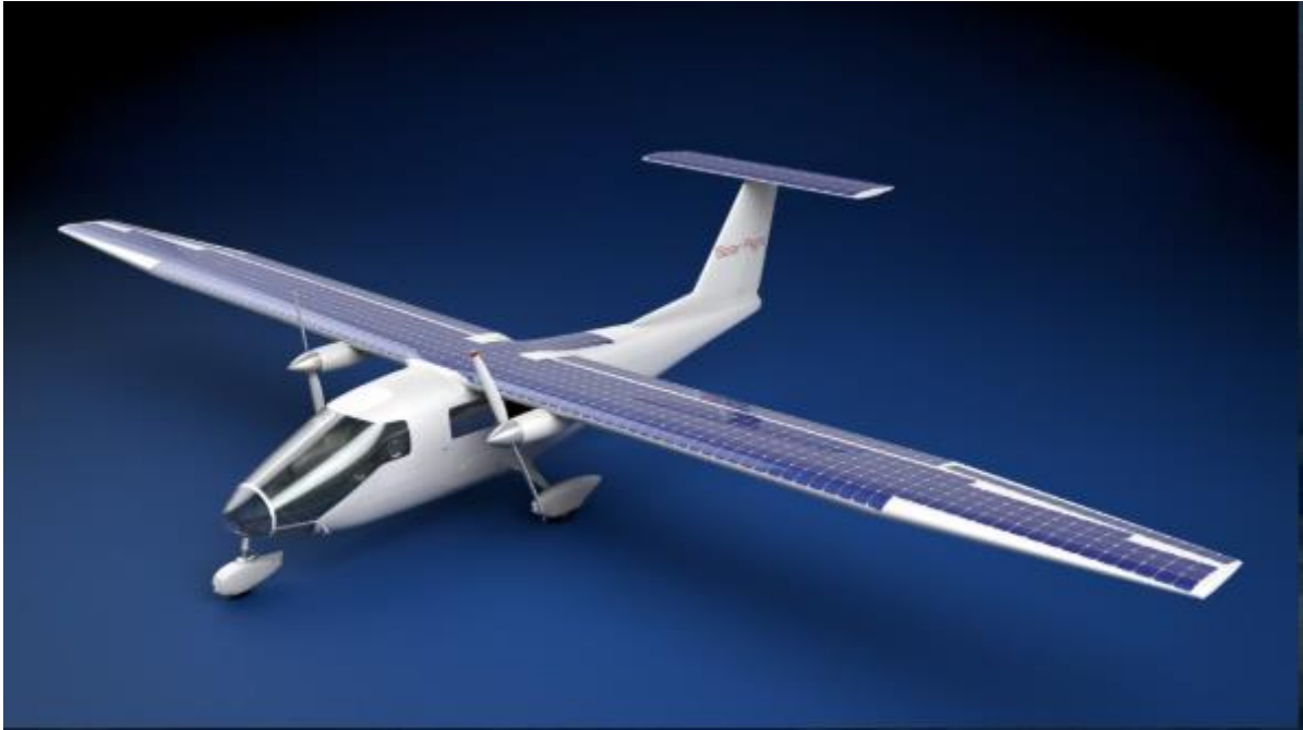
Slika 7. Prikaz solarno-električnog šes zrakoplova sa šest sjedala
