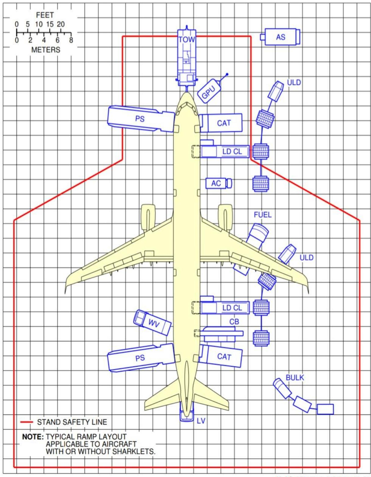
Slika 23. Shema kod prihvata i otpreme zrakoplova Airbus A321
