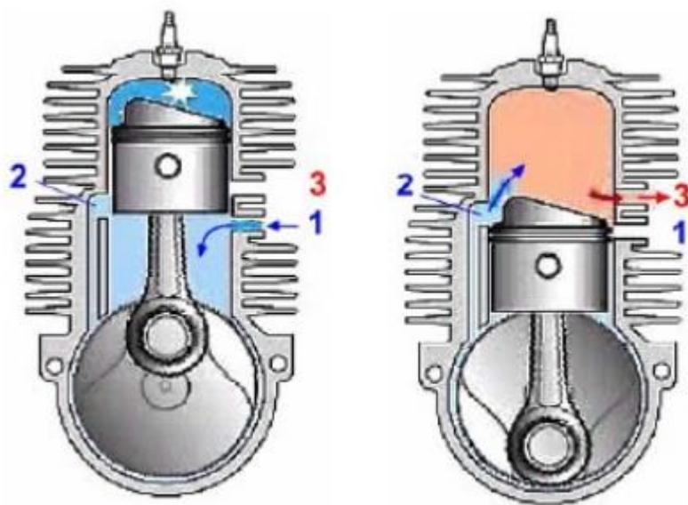
Slika 5. Dvotaktni OTTO-v motor s tri razvodna kanala.
