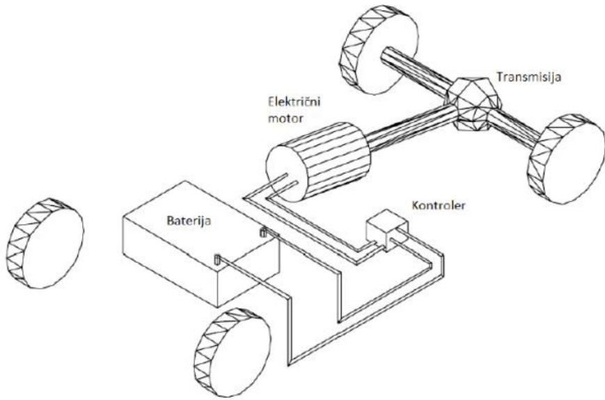
Slika 14. Shema električnog vozila
