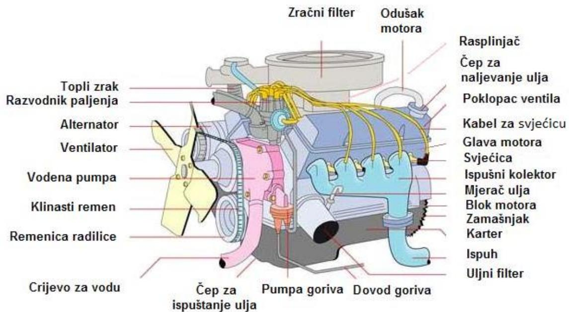
Slika 8. Glavni dijelovi motora s unutarnjim izgaranjem
