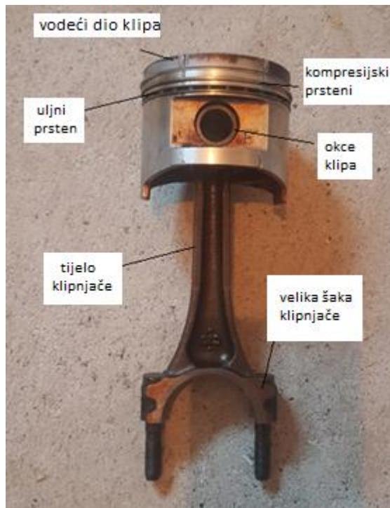
Slika 9. Sastavni dijelovi klipa s klipnjačom
