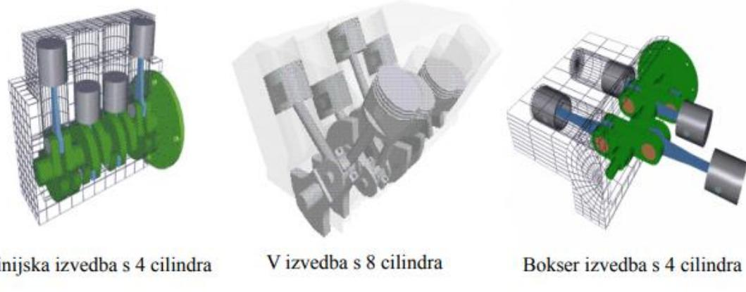
Slika 3. Podjela motora s unutrašnjim izgaranjem prema rasporedu cilindara
