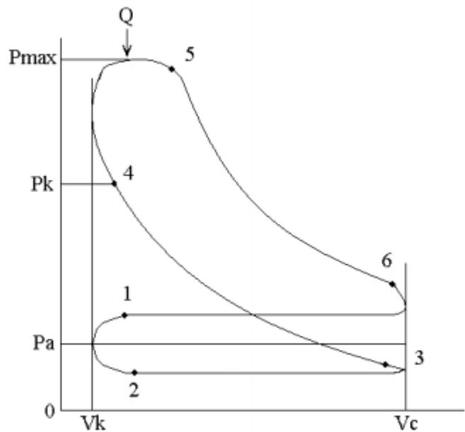
Slika 7. Indikatorski dijagram četverotaktnog motora
