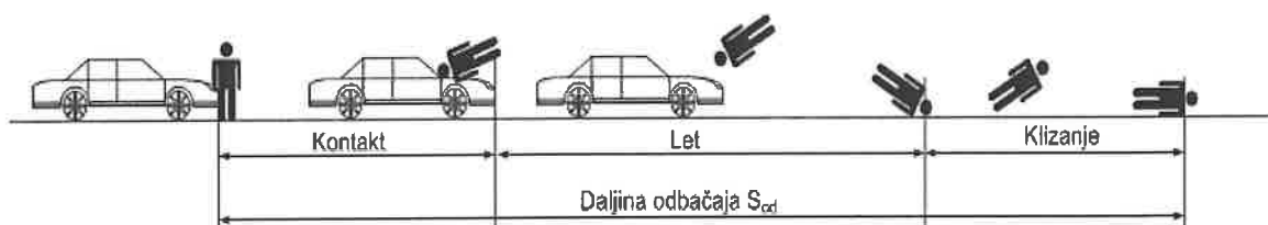
Slika 4. Faze frontalnog naleta na pješaka, [9]
