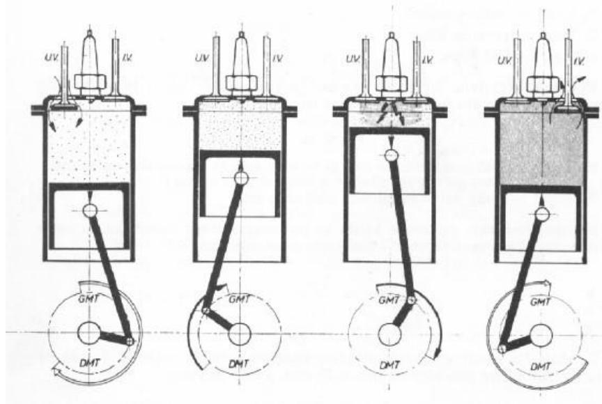
Slika 2: Shema rada Četverotaktnog Otto motora
