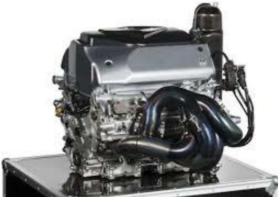
Slika 17. Renault RS27, V8 motor iz 2013. godine
