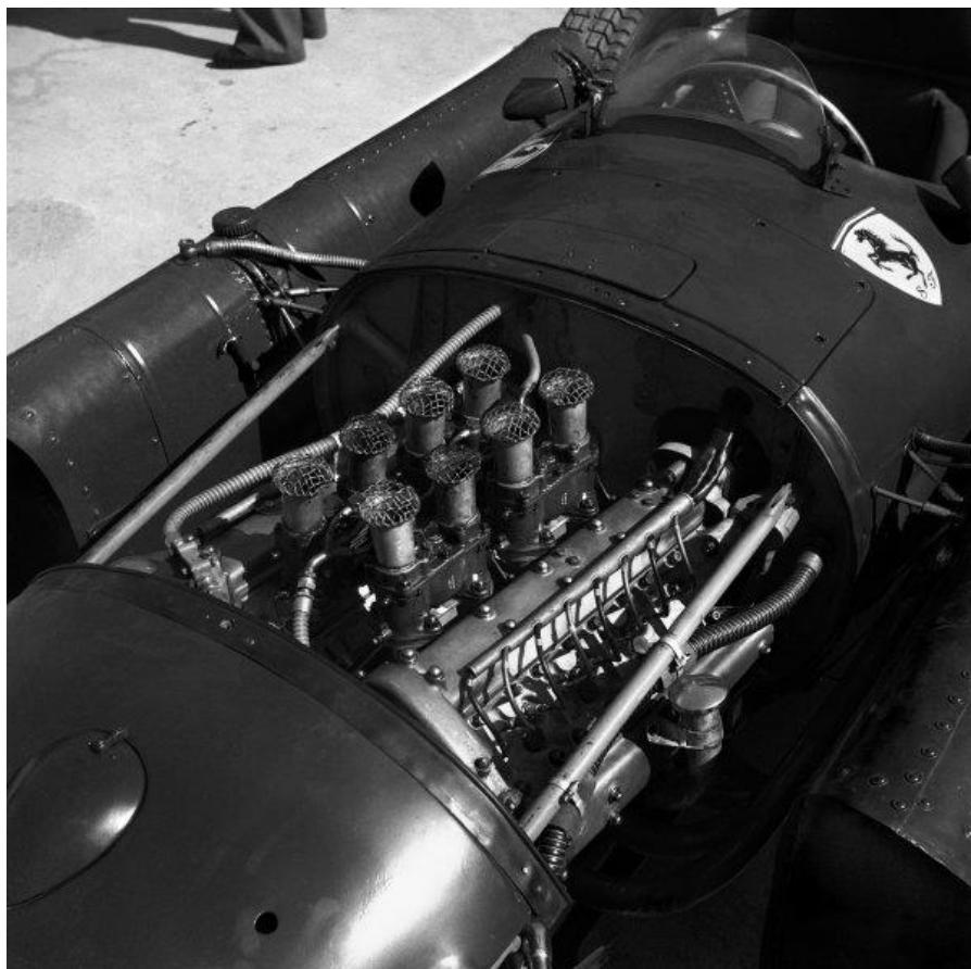
Slika 9. Ferrarijev motor Lancia D50
