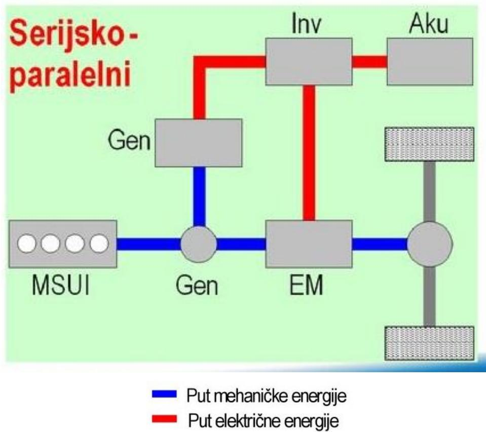
Slika 7. Serijsko-paralelni izvedba hibridnog pogona
