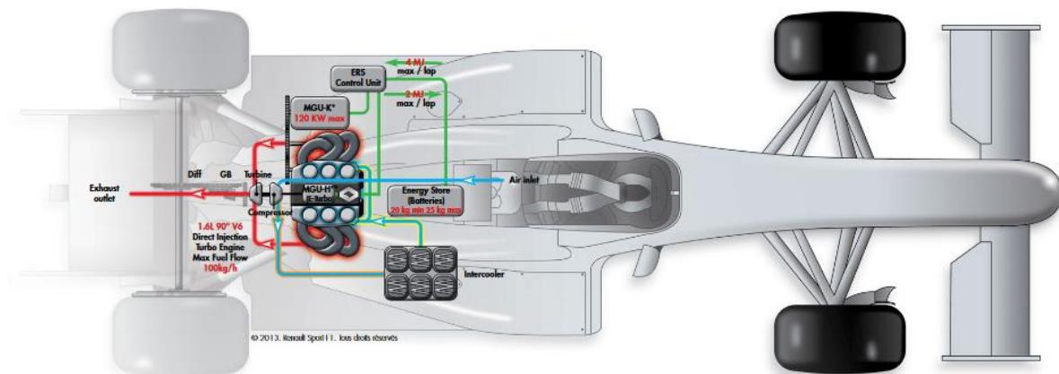
Slika 21. Princip rada hibridnog sustava bolida Formule 1
