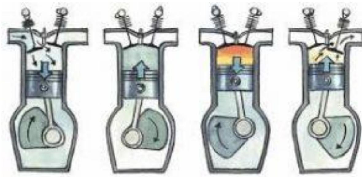
Slika 2. Princip rada četverotaktnog Diesel motora
