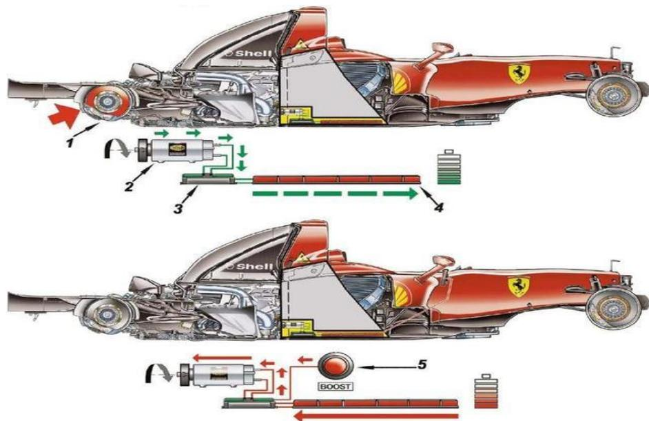
Slika 19. Princip rada KERS sustava
