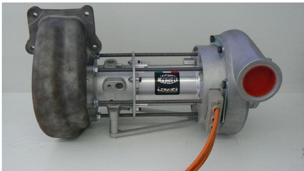
Slika 23. Spoj motor-generatora toplinskog (MGU-H) i turbopunjajuća
