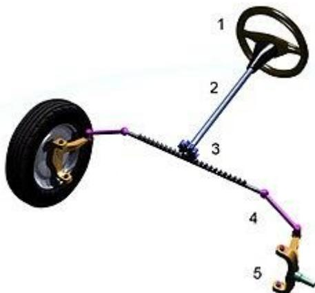
Slika 3. Zupčasti prijenos upravljačkog mehanizma
