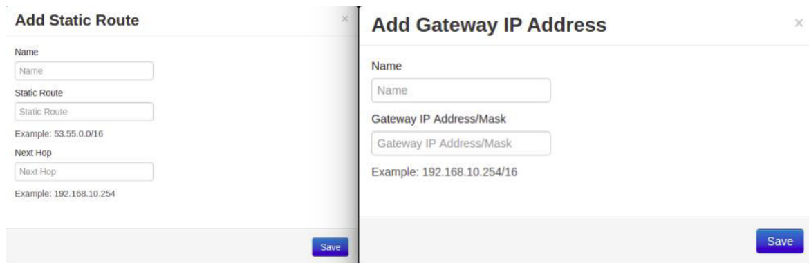
Slika 20. Konfiguracija statičke rute i Gateway -a
