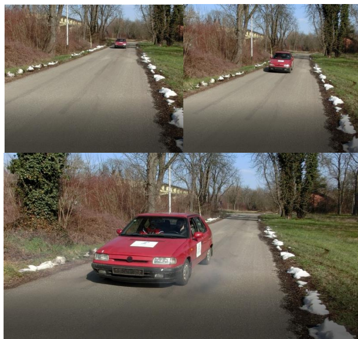
Slika 37. Prikaz kočenja na suhoj podlozi pri brzini od oko 50 km/h
