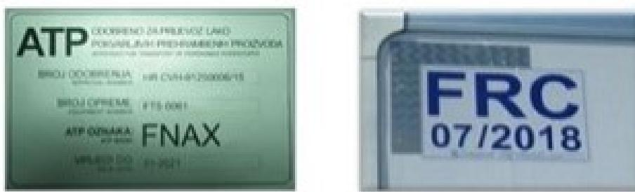
**Slika 20** Pločica za raspoznavanje opreme
