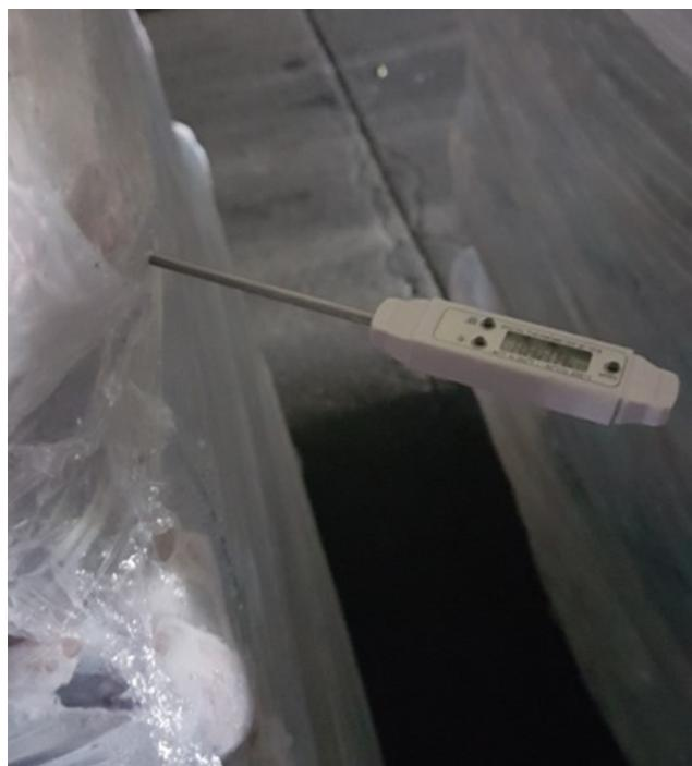
Slika 36 Ubodni digitalni termometar
