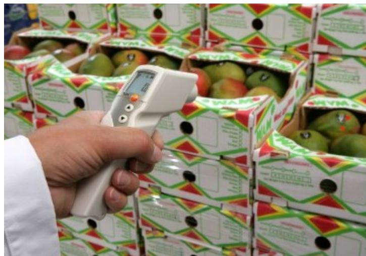
**Slika 18** Laserski termometar
