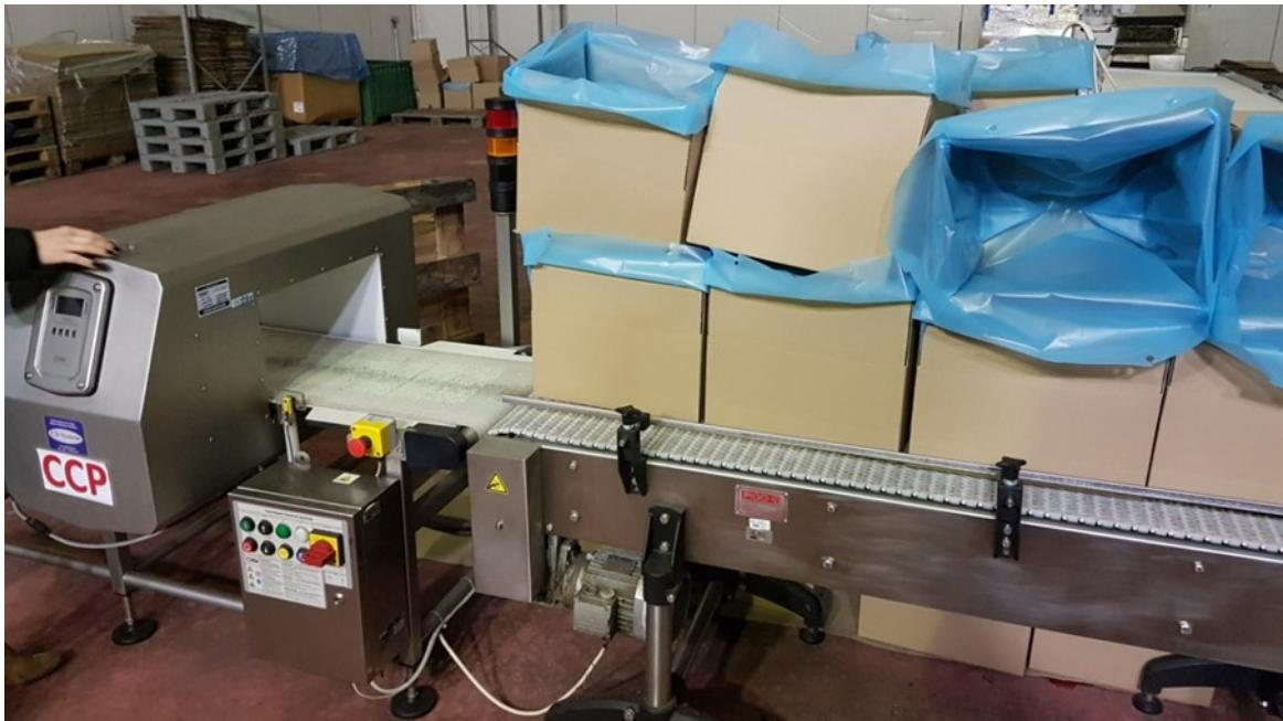
**Slika 55** Uređaj za detekciju metala
