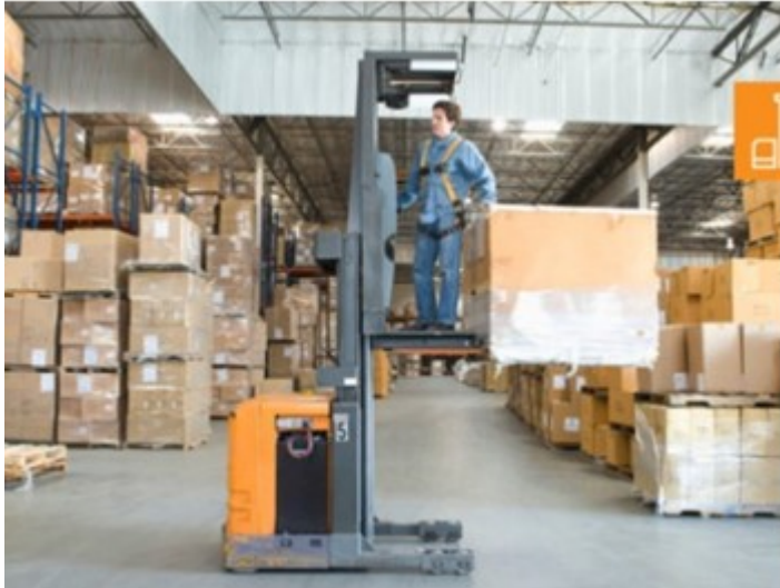
Slika 15 Viličar za podizanje narudžbi
