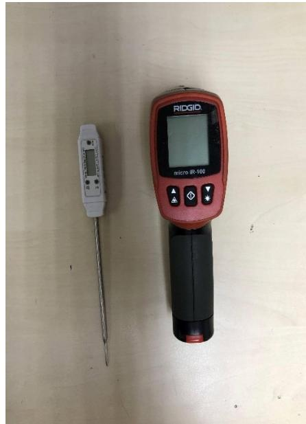
**Slika 18.** Uređaji za mjerjenje temperature robe
