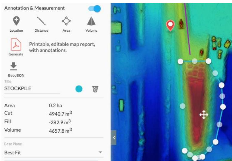
*Slika 37. Mjerenje zaliha pomoću modela digitalne elevacije*
