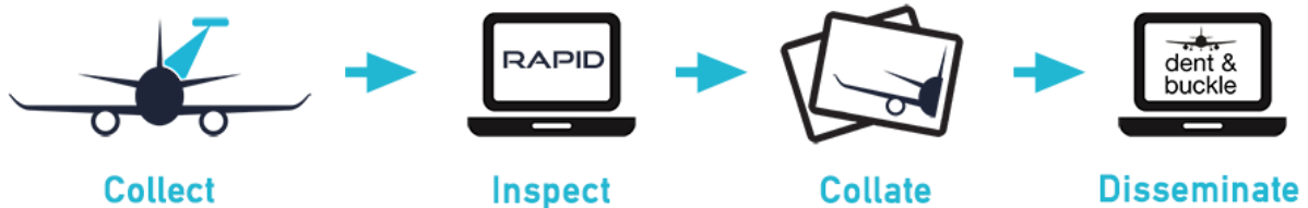
Slika 40. Proces inspekcije zrakoplova dronom
