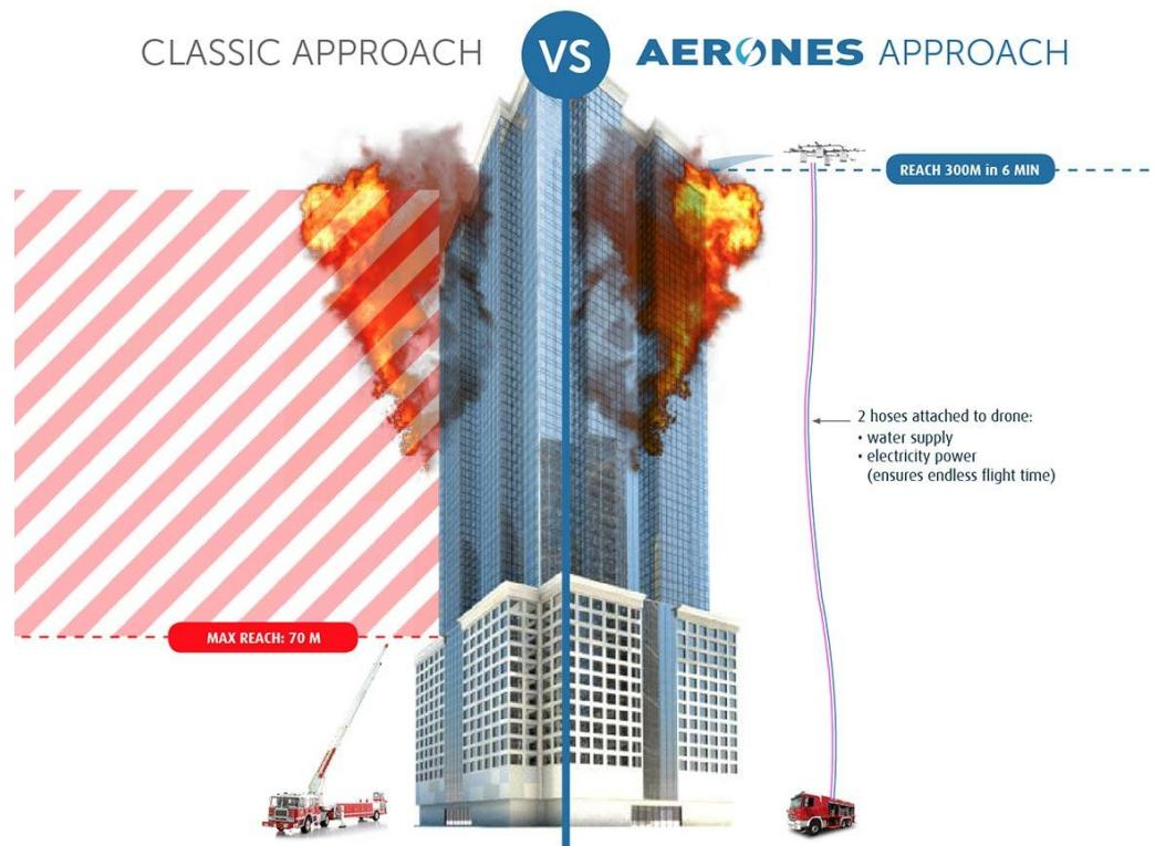
*Slika 33. Usporedba tradicionalnog i budućeg gašenja požara*
