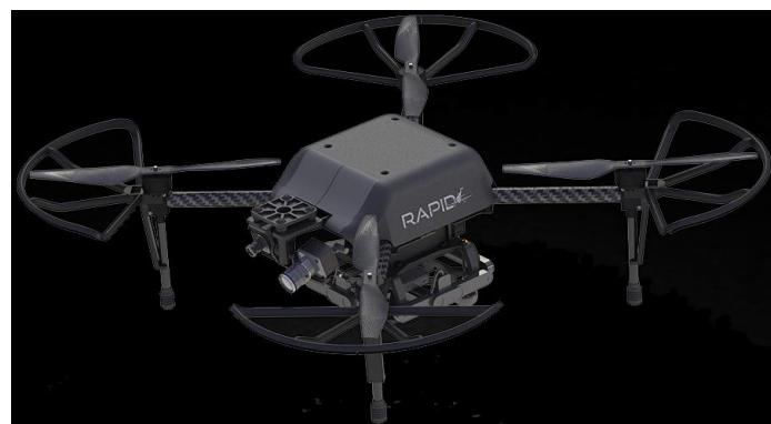
Slika 41. RAPID dron za inspekciju putničkih zrakoplova
