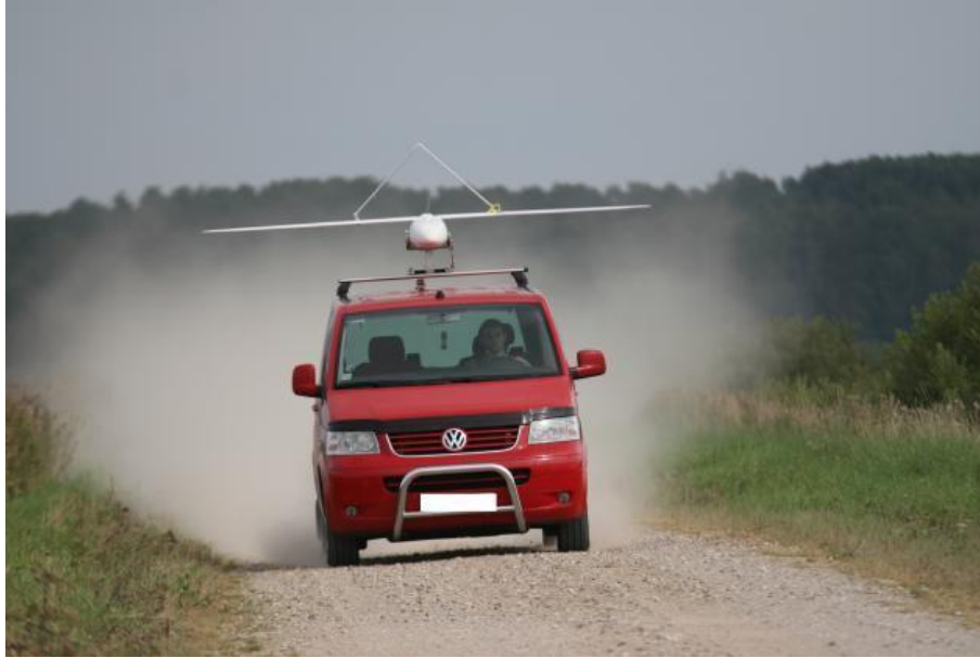
Slika 7. Primjer katapulta na automobilu
