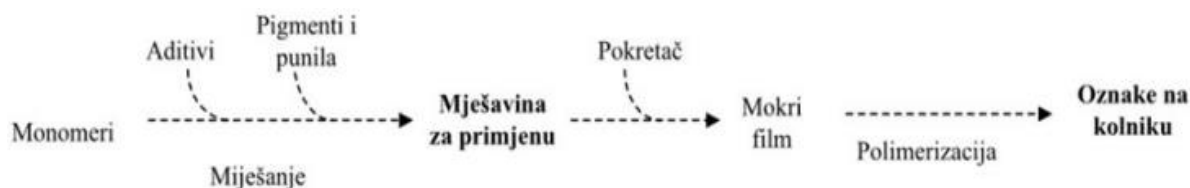
Slika 3. Postupak dobivanja oznaka putem hladne plastike
