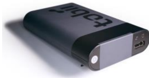
Slika 9. Glavni uređaj za snimanje i pohranu podataka
