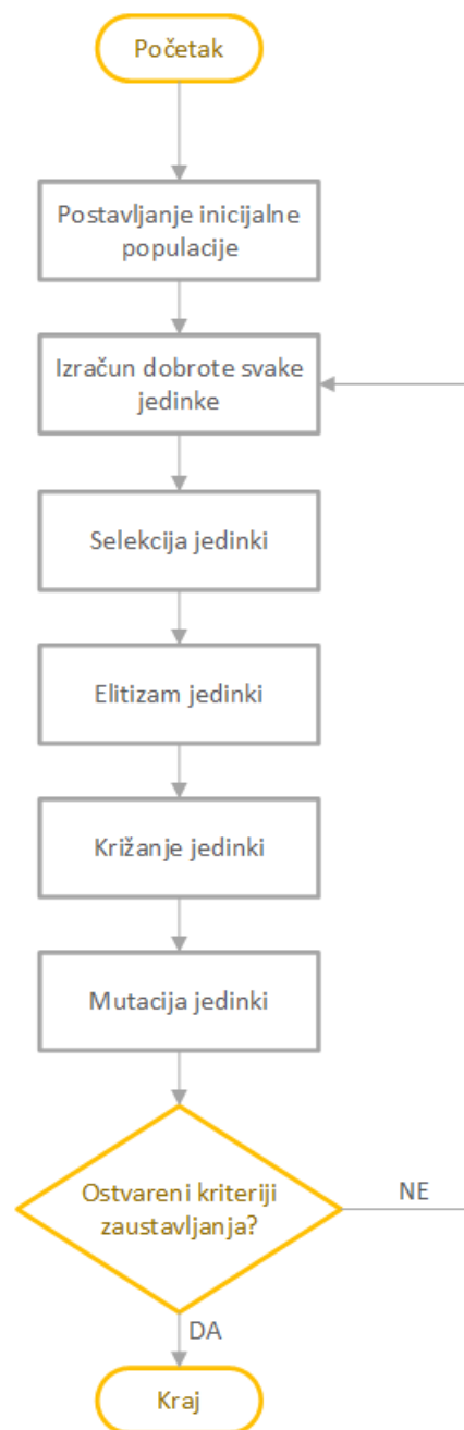
Slika 12: Dijagram toka postupka genetskog algoritma
