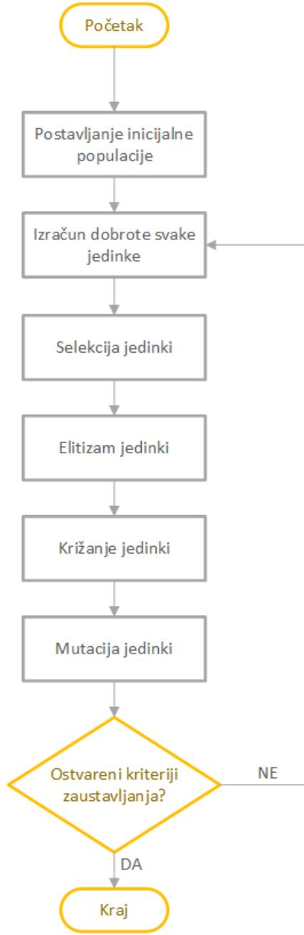
Slika 12: Dijagram toka postupka genetskog algoritma
