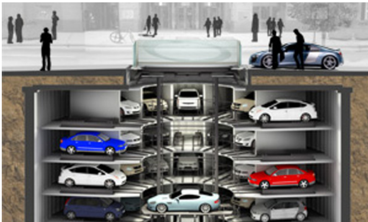
Slika 9: Podzemna automatizirana garaža [15]
