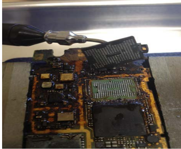
Slika 4: Prikaz odvajanja čipa s matične ploče mobilnog uređaja, [44]
