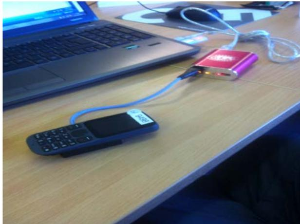
**Slika 5:** Prikaz ekstrakcije mobilnog uređaja korištenjem Flasher Box-a, [50]
