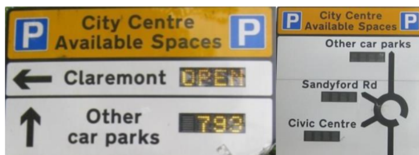
Slika 3-1. Uputni sustav četverokrakog i kružnog raskrižja Izvor: [14]
