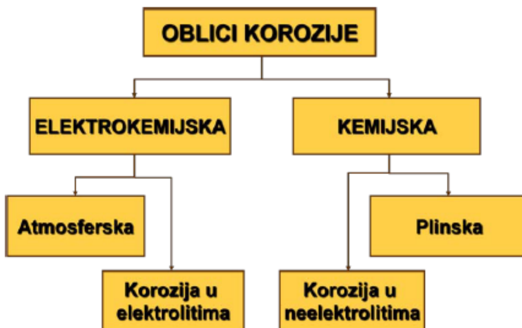
Slika 8. Oblici korozije ovisno o procesu nastanka [4]
