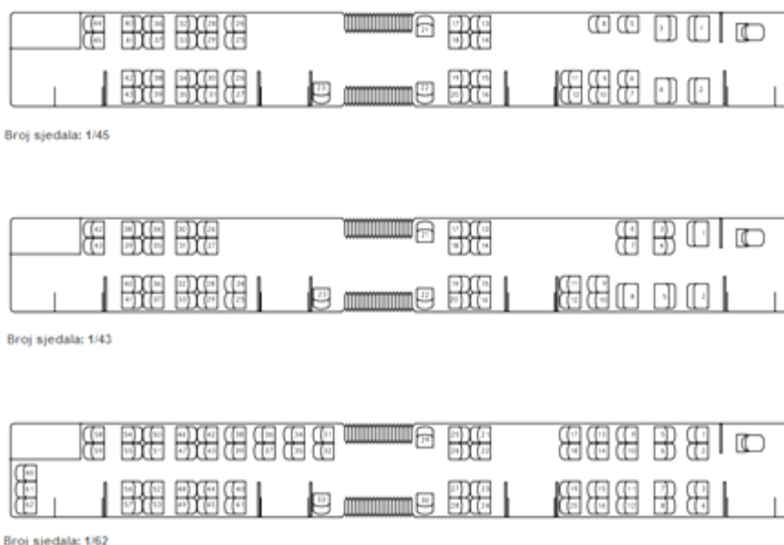
Slika 14. Prikaz rasporeda sjedenja u zglobnom autobusu, [16]
