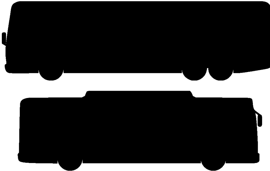
Slika 1. Prikaz troosovinskog i dvoosovinskog autobusa, [6]
