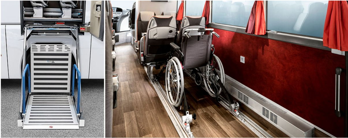
Slika 29. Prikaz rampe i prostora za osobe s invaliditetom, [29, 30]
