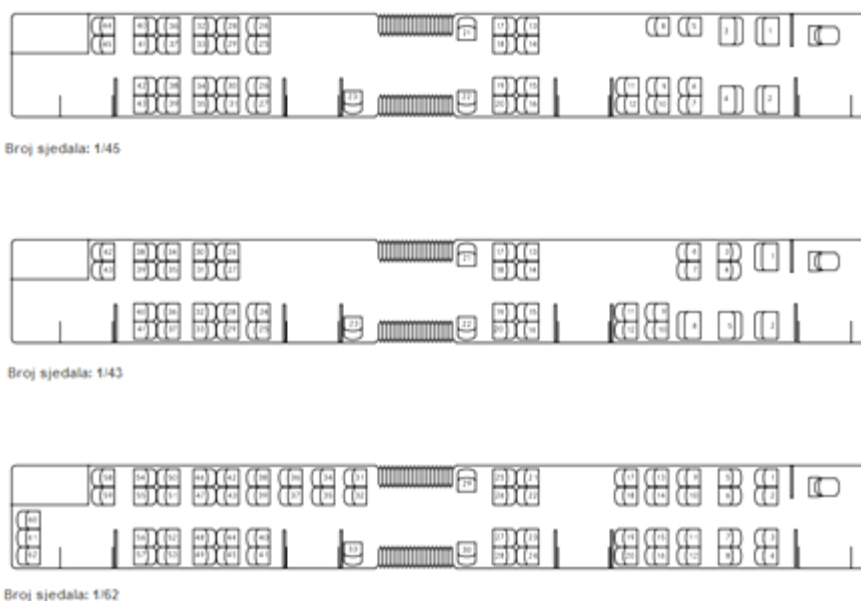
Slika 14. Prikaz rasporeda sjedenja u zglobnom autobusu, [16]
