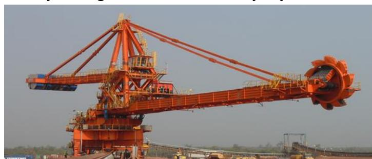
Slika 22. Prikaz uređaja za slaganje i povrat
