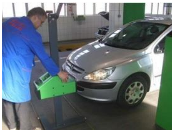
Slika 13. Ispitivanje visine svjetlosnog snopa [14]
