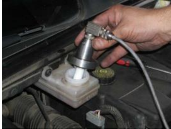
Slika 9. Mjerenje točke isparavanja kočne tekućine [14]
