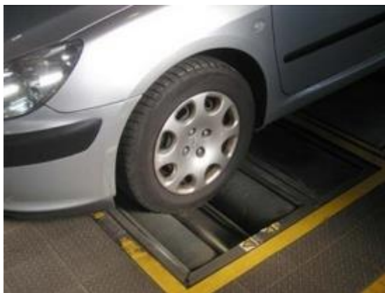
Slika 12. Mjerenje kočne sile [14]
