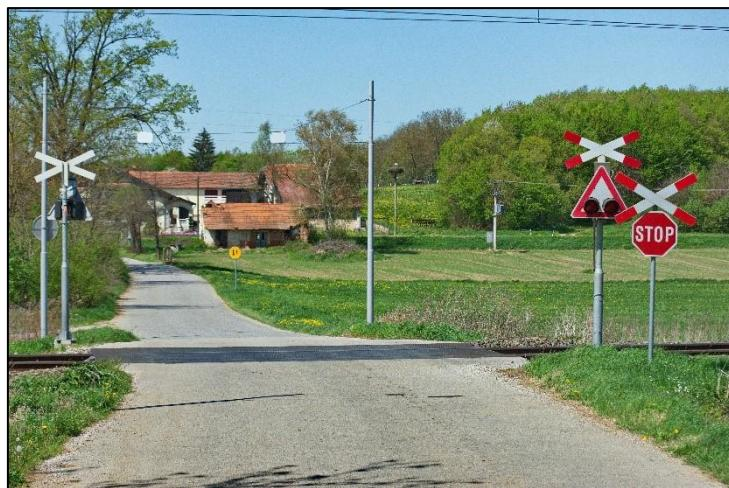
*Slika 11. Željezničko-cestovni prijelaz osiguran svjetlosnim i zvučnim signalima*
