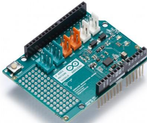
Slika 13.: Arduino 9 axes motion shield
