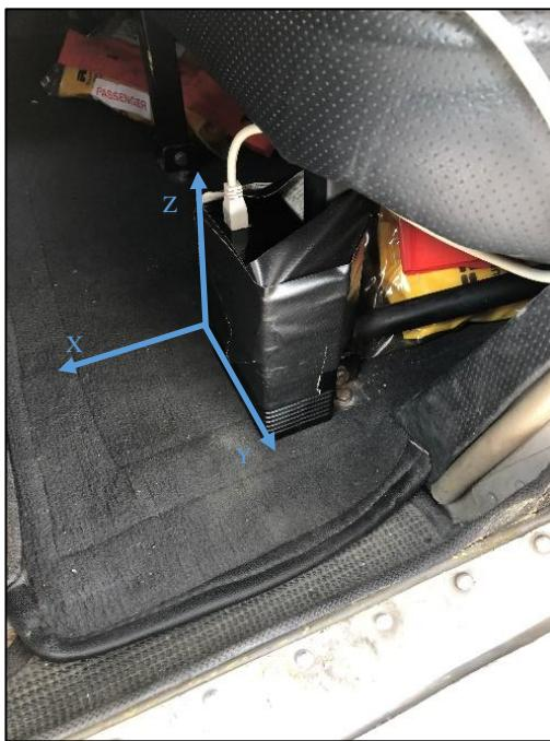
Slika 18. Ugradnja i orijentacija mjernog seta na zrakoplovu
