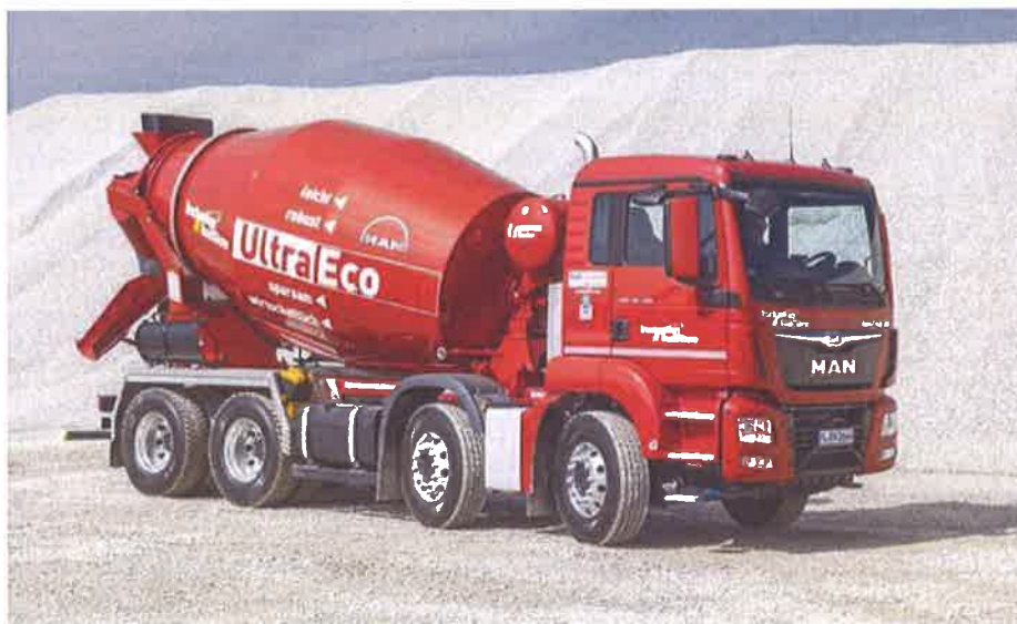
Slika 6. Automješalica za prijevoz betona
