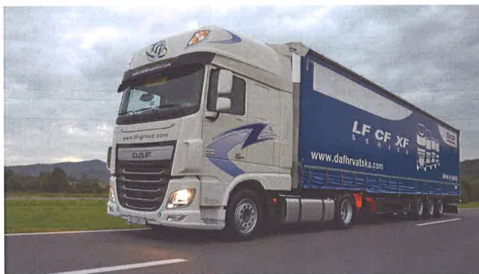
Slika 12. Dvoosovinski tegljač sa troosovinskom poluprikolicom
