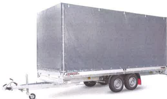
Slika 14. Prikolica za osobna vozila nosivosti 2,6t (sa kočnicom)
