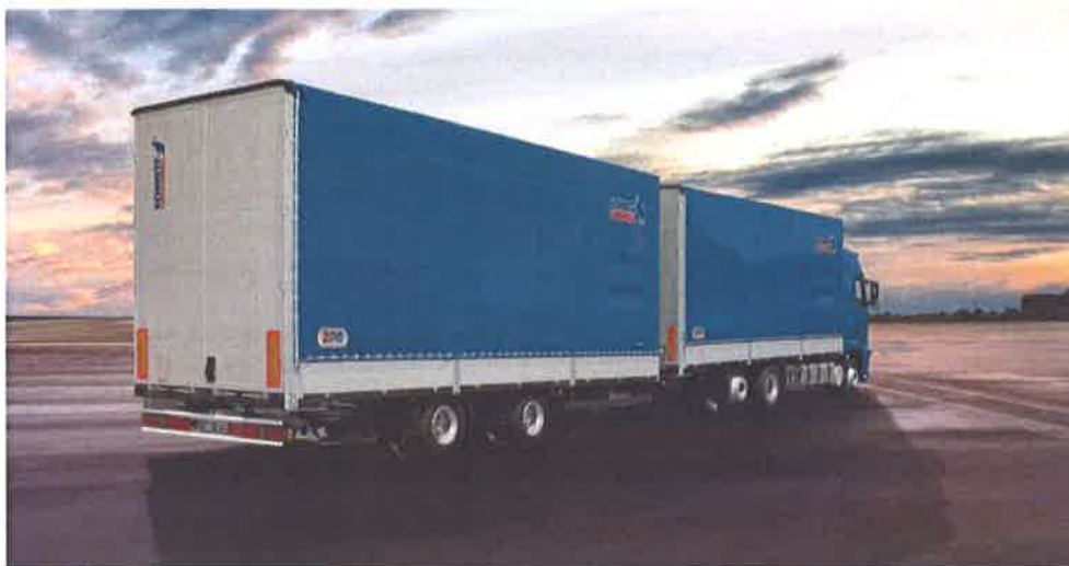
Slika 11. Troosovinski kamion sa prikolicom s dvije centralno smjštene osovine
