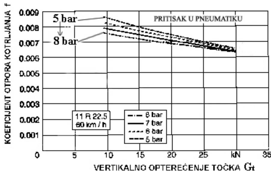
Slika 28: Zavisnost koeficijenta otpora kotrljanju od opterećenja kotača i pritiska u pneumatikima
