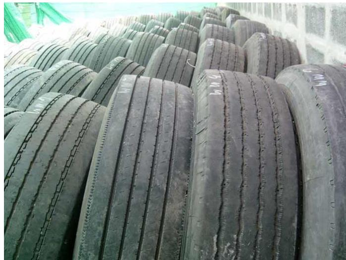
Slika 33: Primjer istrošenih teretnih pneumatika
