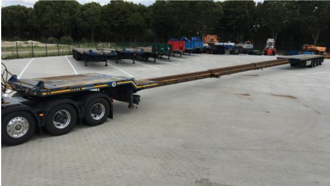
Slika 13: Četveroosovinska plato poluprikolica marke Goldhofer STZ-DL4-46/80 AA
