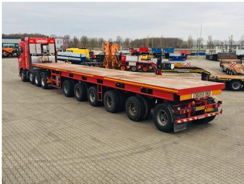
Slika 15: Šesteroosovinska Plato poluprikolica marke Nootboom OVB-102-06
