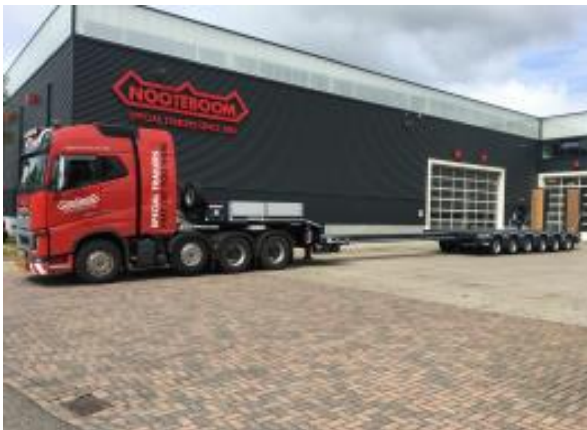
Slika 7: Niskopodna šesteroosovinska poluprikolica marke Nootboom Stepframetrailer MCO-85-06V
