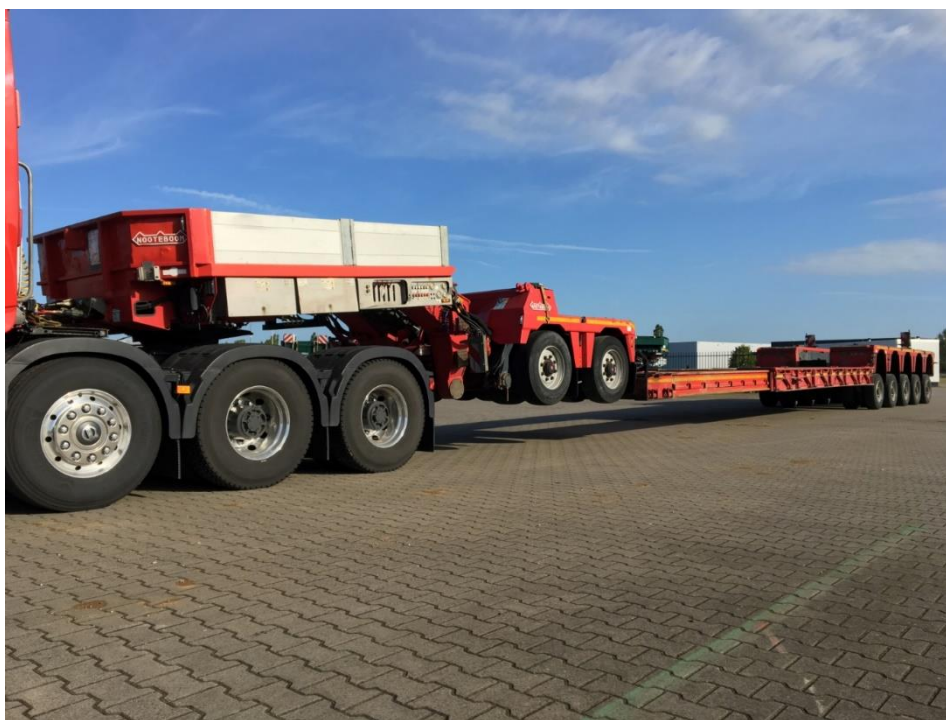
Slika 11: Trodijelna niskopodna sedmeroosovinska poluprikolica marke Nootboom EURO-128-25 (ICP)
