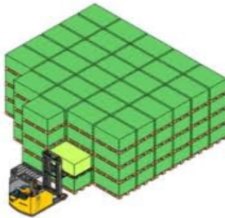
Slika 8. Način podnog skladištenja - blokovi
