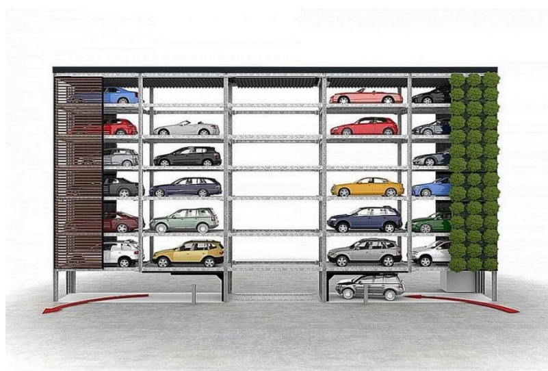
Slika 20. Djelomično mehanizirana garaža s dizalom; [8]
