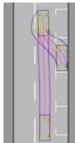
Slika 2. Putanja uzdužnog načina parkiranja; [1]
