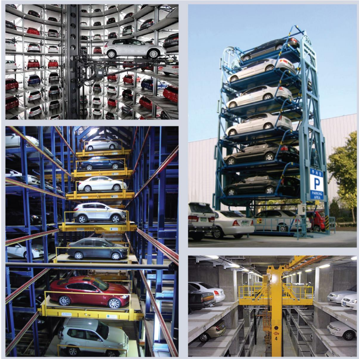
Slika 11. Primjeri potpuno mehaniziranih garaža [15] [16] [17] [18]
