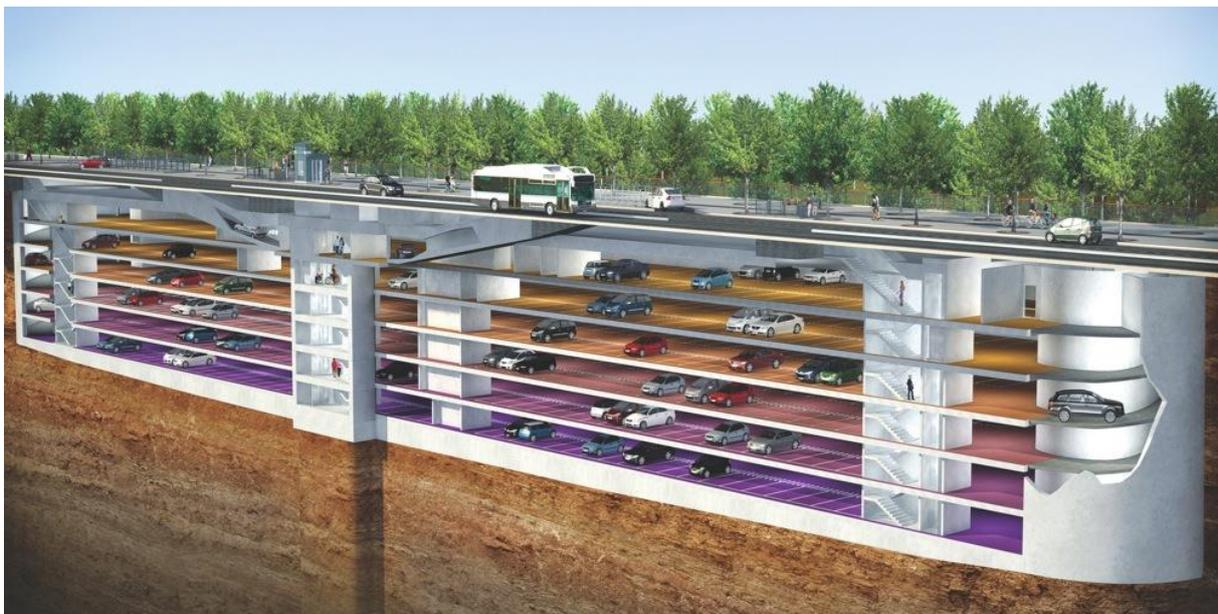
Slika 5. Grafički prikaz podzemne garaže u više razina sa iskorištenim nadzemnim dijelom [13]
