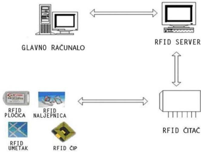
Slika 1. Princip rada RFID tehnologije
