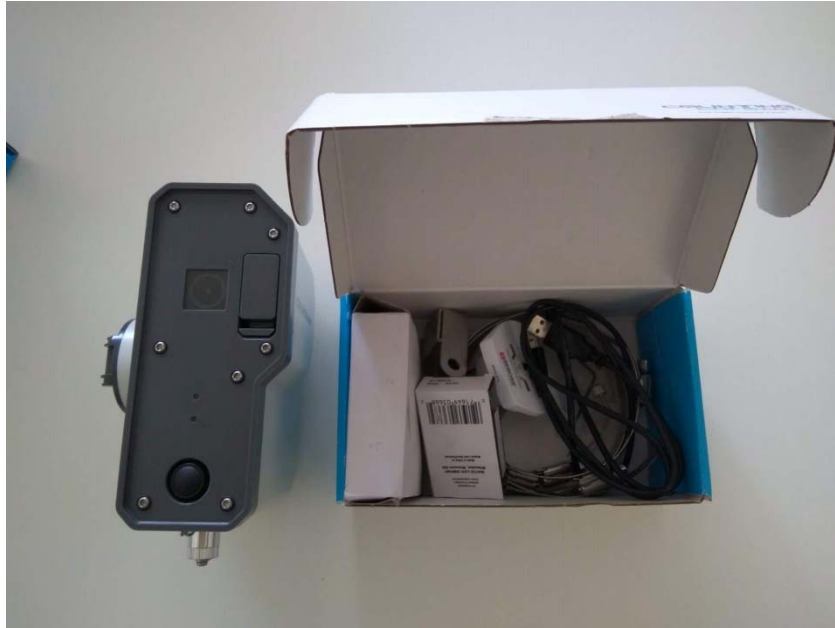
Slika 13. Kamera za kontinuirano snimanje prometa COUNTcam
