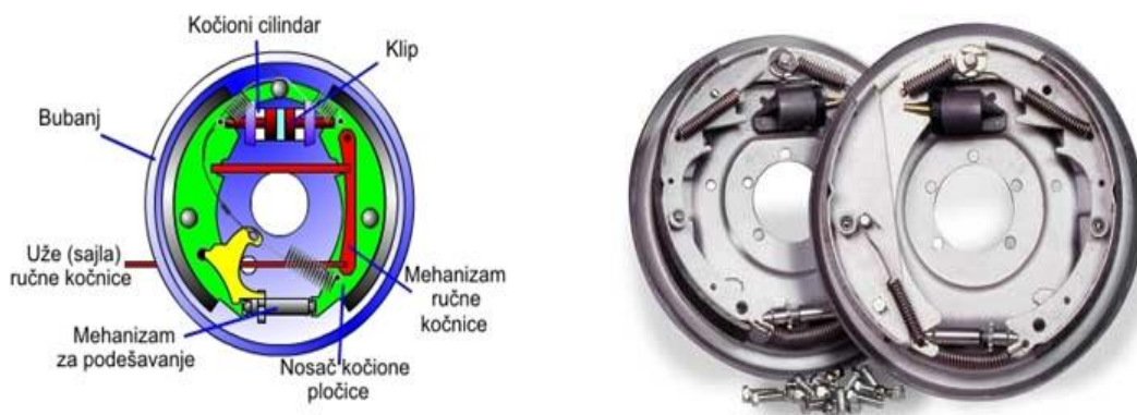
Slika 2. Konstrukcija bubanj kočnice
