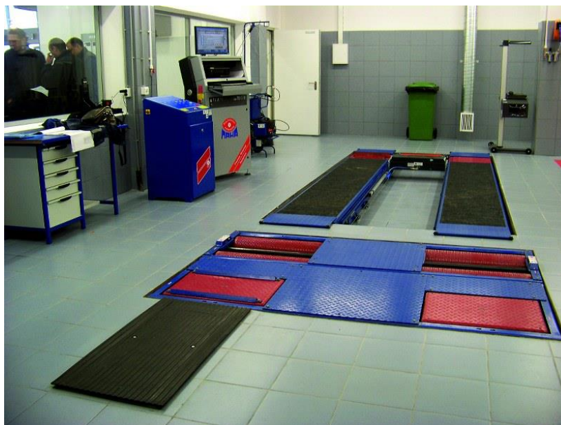
Slika 22. Valjci za kontrolu kočnica u servisnoj radionici
