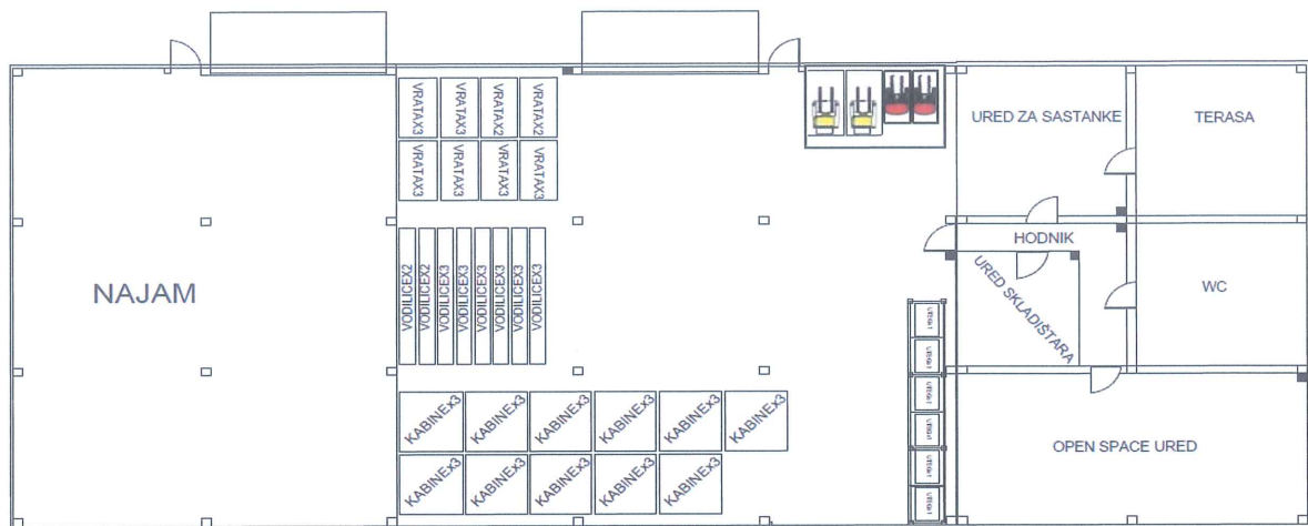
Slika 35: 5. faza - prijedlog rješenja skladišnog objekta odlaganjem teretnih jedinica u blokove za 11 teretnih jedinica u slučaju iznajmljivanja dijela skladišnog objekta
