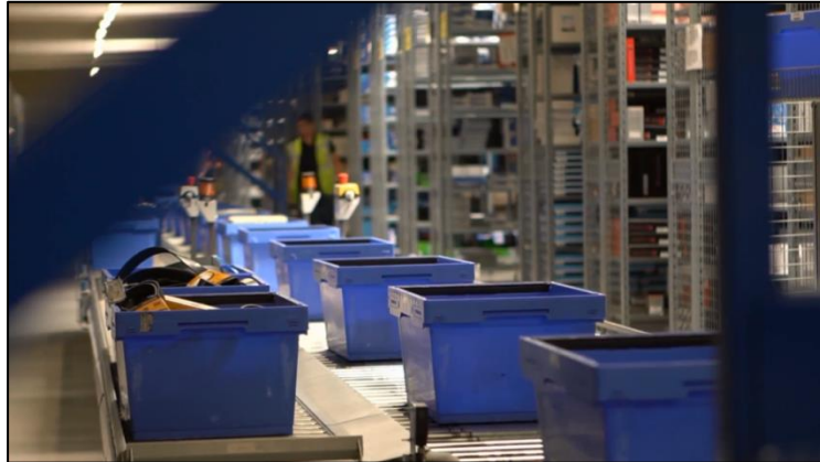
Slika 21. Konvejska traka sa kutijama za komisioniranje
