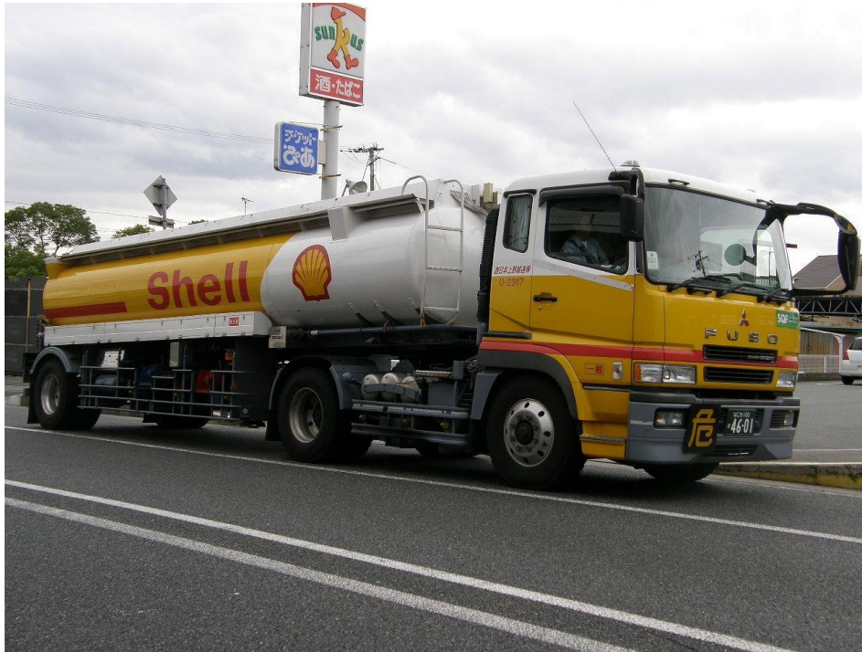
Slika 5. Skup vozila kojeg čini tegljač s poluprikolicom cisternom
