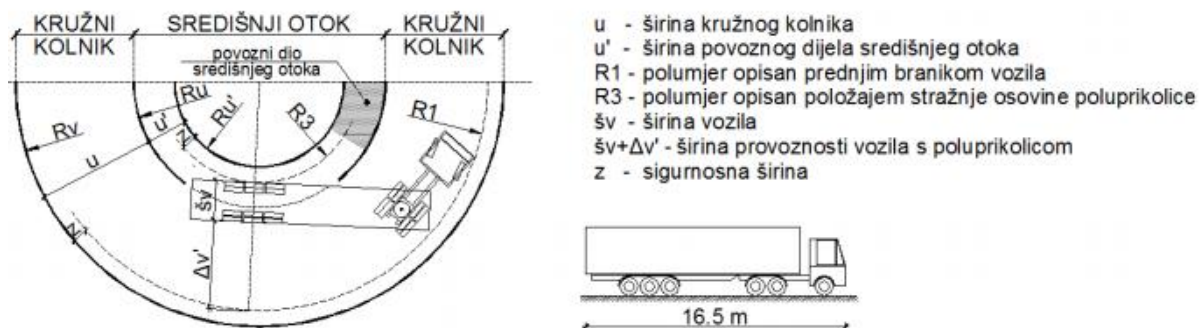
Slika 8. Širina povoznog djela središnjeg otoka za mjerodavno dugo vozilo
