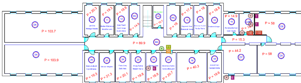
Slika 25 Prikaz položaja pristupnih točaka na katu i pripadajućih kanala. Zelenom bojom su prikazane pristupne točke Eduroam mreže.
