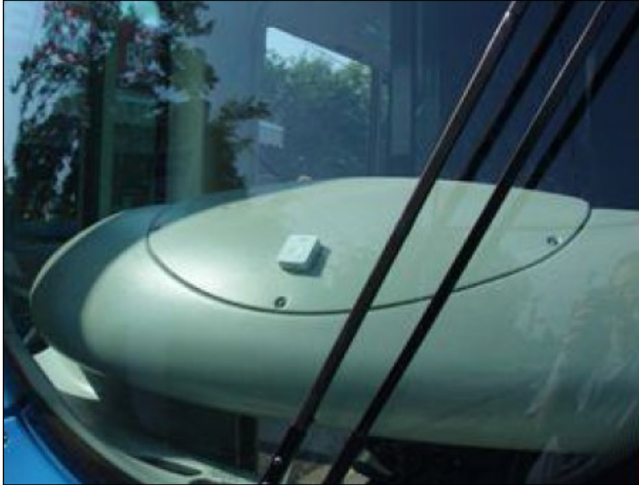
Slika 12. Primjer pozicioniranja GPS lokatora u kabini tramvaja TMK2200.
